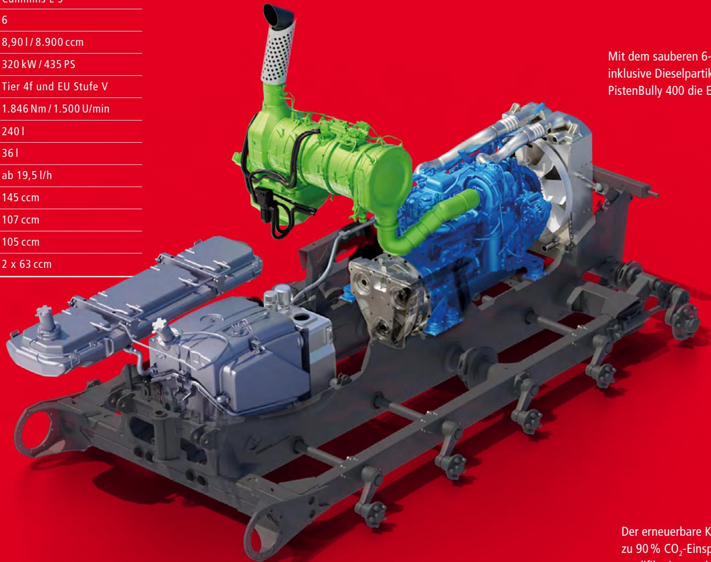
Mit dem sauberen 6-Zylinder-Motor mit 435 PS inklusive Dieselpartikelfilter erfüllt auch der PistenBully 400 die EU Stufe V / EPA Tier4 final.
