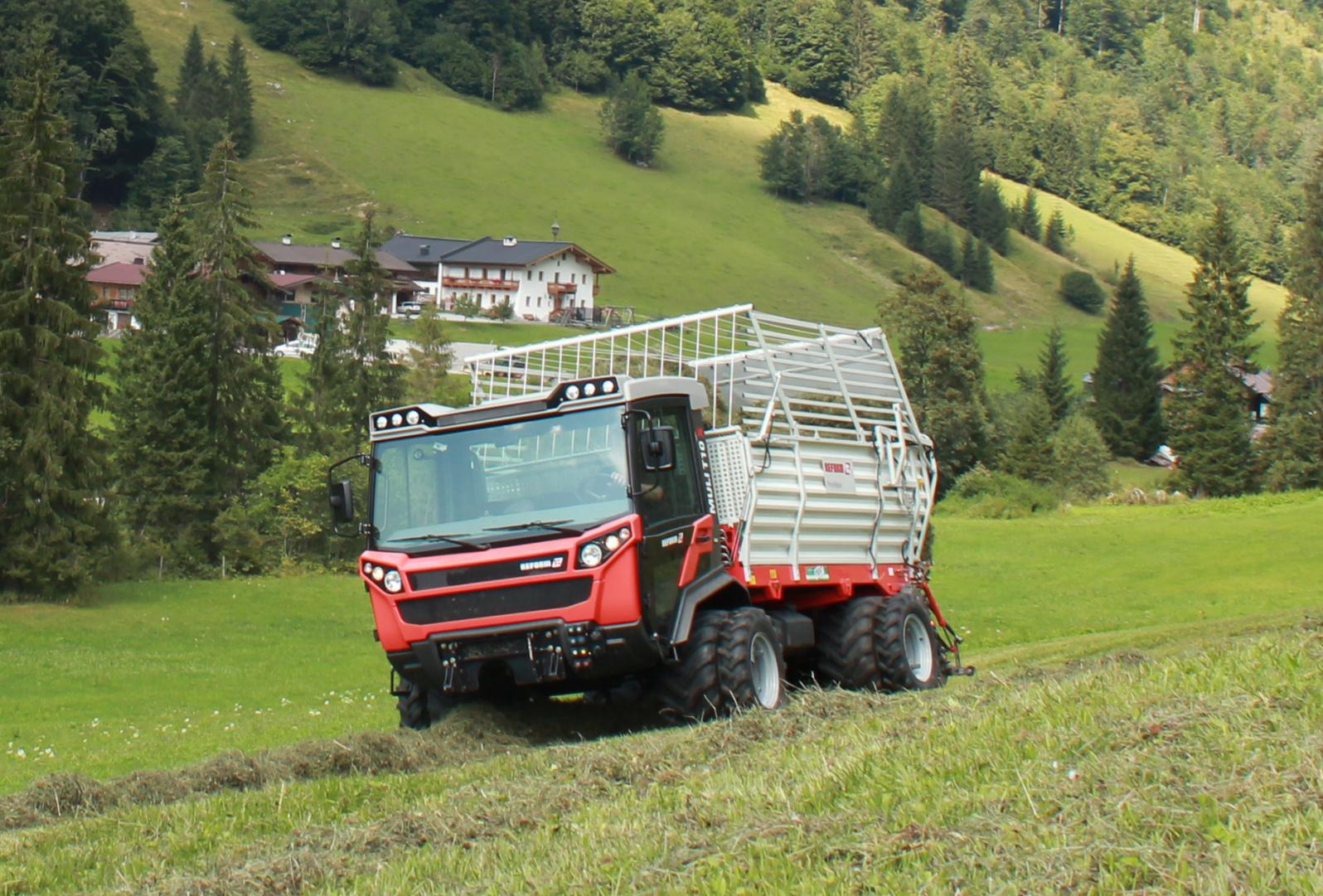
...hydrostatischer Antrieb im Arbeitseinsatz
