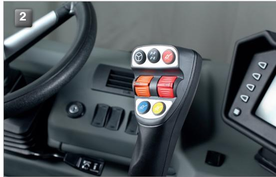
Je nach Arbeitseinsatz kann der Bediener zwischen dem Schaltgetriebe (1) und dem stufenlosen Getriebe (2) wählen. Die Umschaltung erfolgt mittels Schalthebel.
