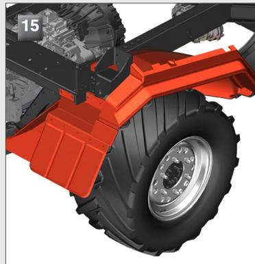
Die Vorder- und Hinterachse sind als **Portalachsen (13)** ausgeführt. Diese Bauweise ergibt eine größtmögliche Bodenfreiheit, mit entsprechender Durchgangsweite zwischen den Rädern. Die Bodenfreiheit beträgt 450 mm.
