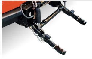
Das **Front-3-Punkt-Hubwerk** mit Gabeln ist mit elektrohydr. Geräteeinlastung sowie Schwingungsdämpfung erhältlich.
