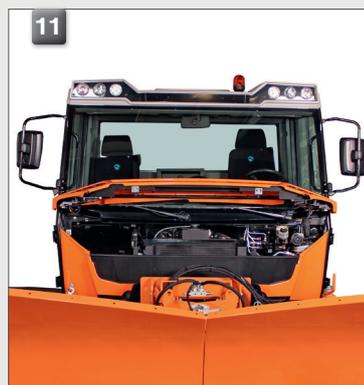
Die **serienmäßige Kippkabine (10)** des Muli T10 X ermöglicht es für Wartungs- und Reparaturarbeiten rasch an den Motorraum zu gelangen. Die werkzeuglos, hydraulisch zur Seite kippbare Kabine lässt sich in kürzester Zeit anheben. Durch das seitliche Kippen müssen Frontanbaugeräte wie ein Mähwerk oder ein Schneeflug nicht demontiert werden.
