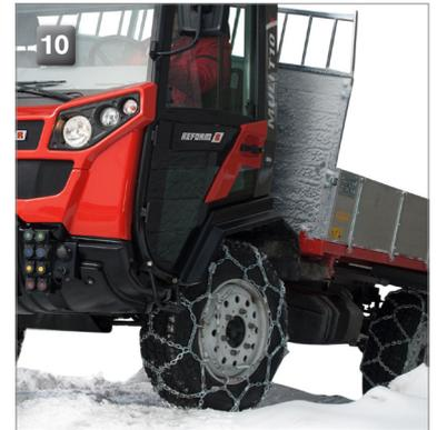
Zwischen Vorder- und Hinterachse sorgt das 360° drehbare **Zentralgelenk (10)** für ständige Bodenhaftung aller 4 Räder und gewährleistet sicheres Fahrverhalten in jeder Situation. Sie haben volle Kraftübertragung und optimale Bodenschonung auch im unwegsamen Gelände.
