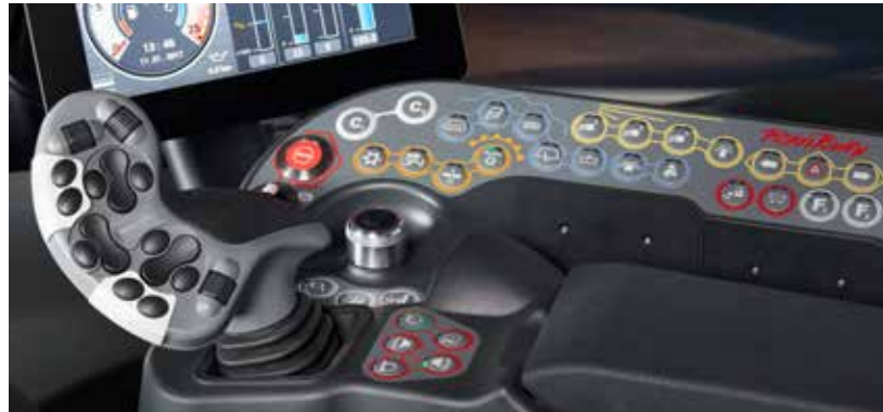
Armauflage mit komfortabel bedienbaren und individuell belegbaren Kundentasten.
