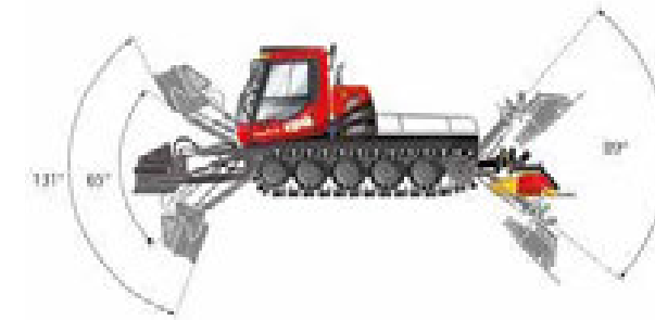
Extreme Beweglichkeit der Front- und Heckzusatzgeräte für perfektes Shaping und Reshaping
