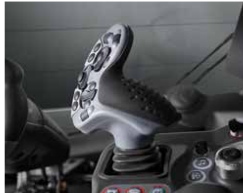
Joystick mit ergonomischer und proportionaler Steuerung für intuitives Arbeiten.
