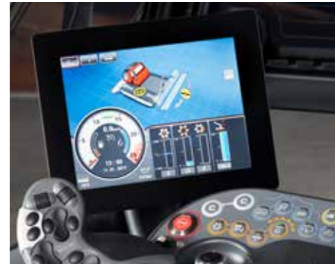
Patentiertes iTerminal mit optimierter Benutzerführung durch farbige Kennzeichnung der aktiven Bereiche des Fahrzeugs.
