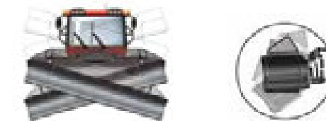
Die maximale Flexibilität des 12-Wege-Räumschildes macht präzises Gestalten besonderer Formen möglich.
