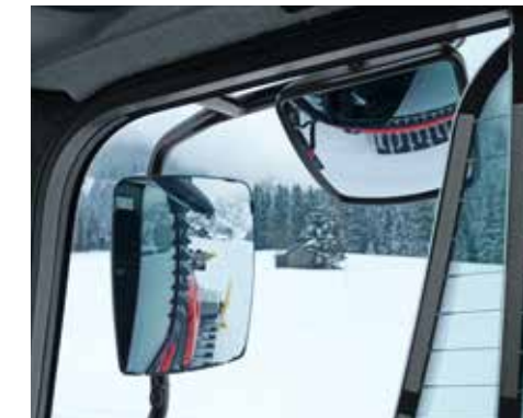
Rampenspiegel sorgen für direkte Sicht auf die Ketten.
