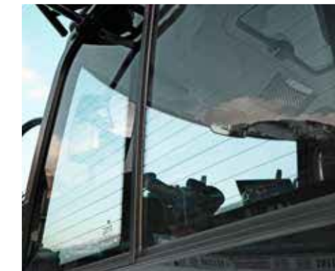
Doppelt verschiebbare und in jeder Position beheizbare Seitenscheiben für seitlich optimale Sicht.
